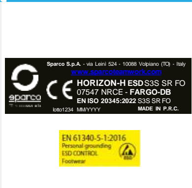
ETIQUETA "CE" en el interior de la lengüeta (50 x 15 mm) ETIQUETA ESD EN 61340-5-1:2016
